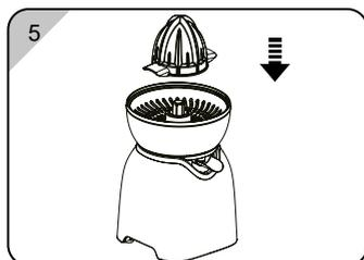
Установите насадку-конус на вал электродвигателя, насадка будет располагаться над сеткой-фильтром.
