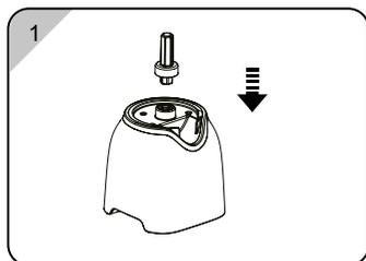
Установите вал электродвигателя на моторное основание.
