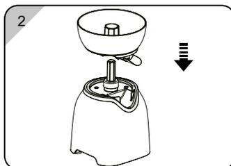
Установите емкость для сока на моторное основание (шаг 1). Вал электродвигателя должен проходить посередине емкости для сока. Закрутите емкость для сока, чтобы надежно закрепить её.
