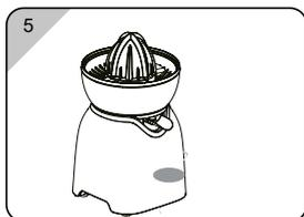
Снимите насадку-конус, потом извлеките сетку-фильтр.
